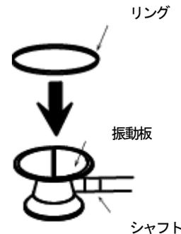
**6. 振動板の着脱方法 (図はダブルタイプ)**
